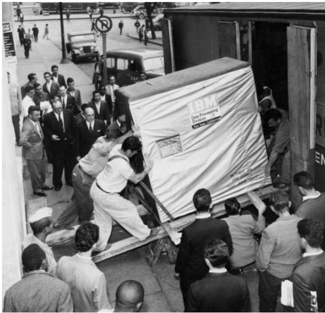
Мал. 2.2. Навантаження для перевезення 5-мегабайтного жорсткого диска компанії IBM, 1965 рік (США) (ліворуч) та 10-ти терабайтний диск фірми Western Digital, 2016 рік (праворуч)
